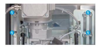
1. Les quatre vis hexagonales (1) de la console sont légèrement desserrées afin que l'unité d'engrenage, y compris la roue dentée, puisse être poussée vers le haut par les ressorts à gaz. La roue dentée et la crémaillère doivent alors s'engrener l'une dans l'autre.
